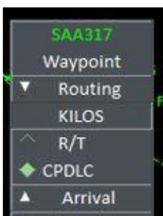
Aparece el punto que elegimos previamente, y automáticamente seleccionada la opción CPDLC. Al hacer click en el punto (KILOS) automáticamente se enviará el mensaje al piloto:
